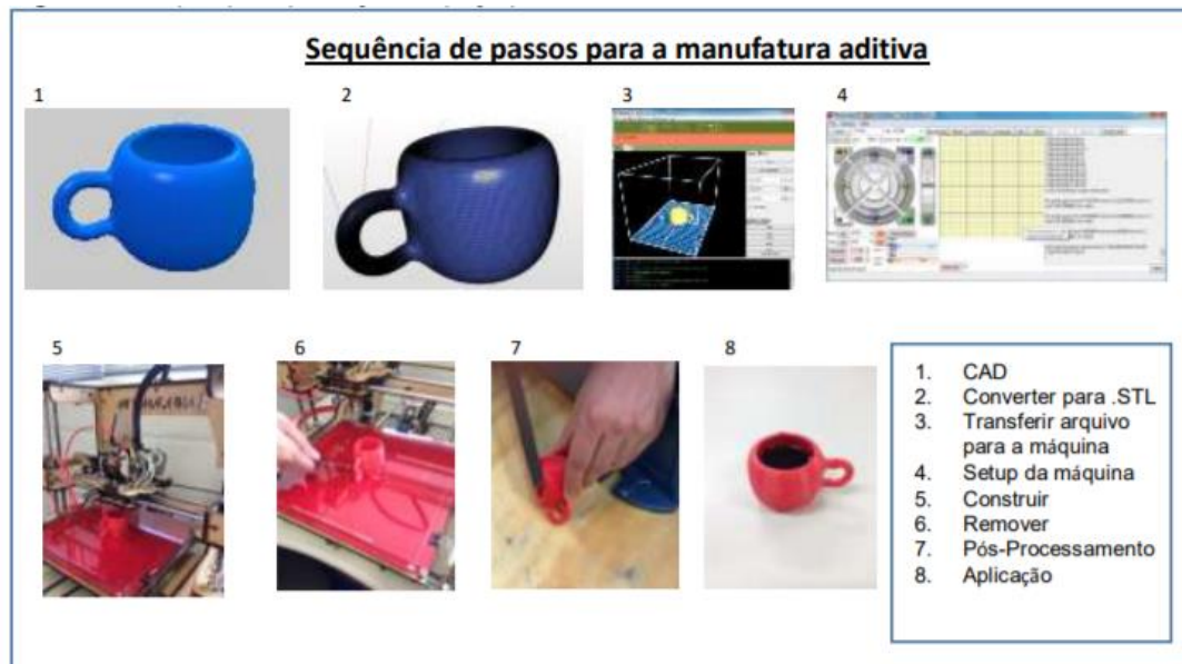
Figura 11: Etapas para a produção de uma peça em manufatura aditiva[28]
