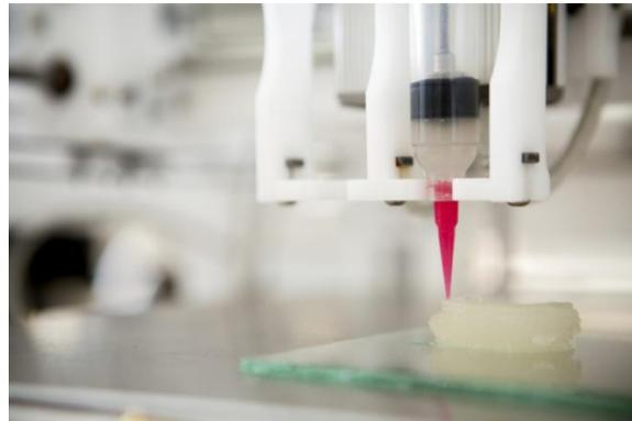
Figura 21: Orelha impressa através de Impressora 3D[56].
