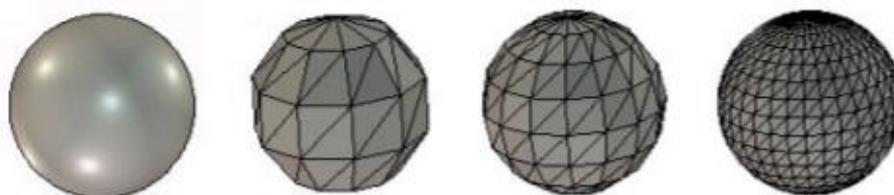
Figura 10: Efeito de Refinamento da malha de triângulos na forma final da peça[26].
